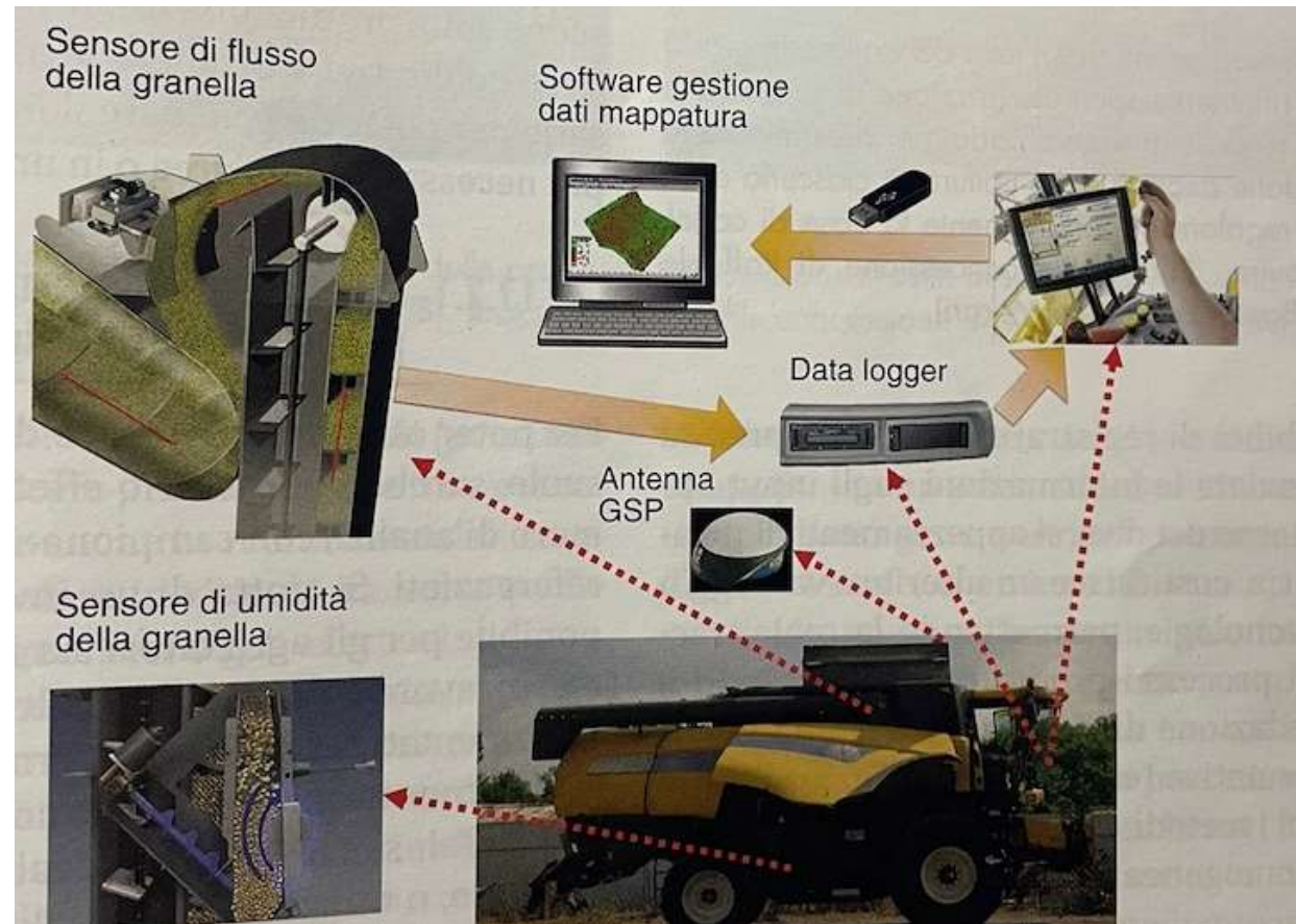
Mapa de produtividade instalado numa ceifeira debulhadora
