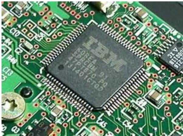
O chip é uma fina placa de semicondutor que reúne dentro de si todos os componentes necessários (díodos,
